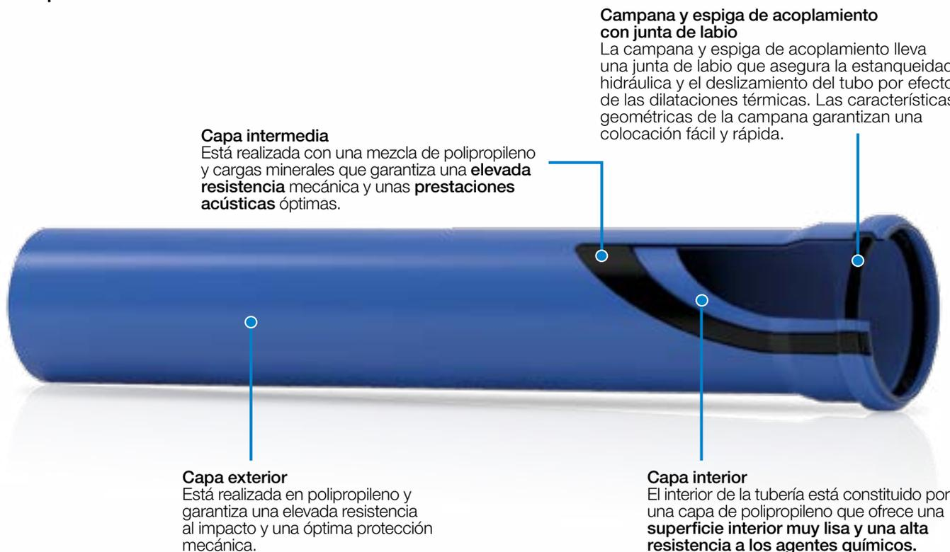
La capa intermedia está realizada con una **mezcla patentada a base de polipropileno (PP) y cargas minerales (MF)** que otorgan al sistema Triplus® unas características mecánicas excelentes tanto a las bajas temperaturas (resistencia al choque hasta -25°C) como a las altas (hasta 95°C).
